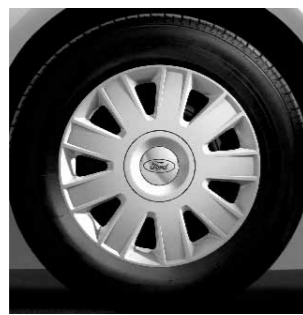
Стальной колесный диск 15" с 9 спицевым декоративным колпаком (Стандартная комплектация варианта Ambiente)
