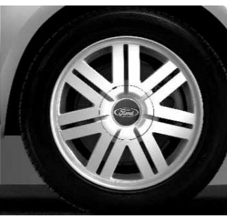
Легкосплавный полированный колесный диск 16" с 7x2 спицами (Стандартная комплектация варианта Ghia)
