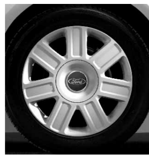
Стальной колесный диск 16" с 7-спицевым декоративным колпаком (Стандартная комплектация варианта Trend)
